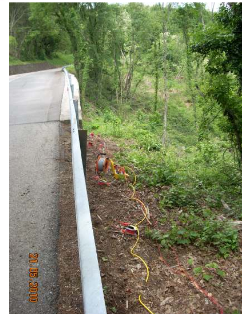
Figura 11 Tomografia elettrica eseguita con la configurazione Dipolo-Dipolo.
